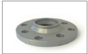
Artikel-Nr./Part-no. 202345714: Radnabellänge max. 16 mm. Felgeninnenfase mind. 7x45° Wheel hub length max. 16 mm. Inner bavel 7x45°.
