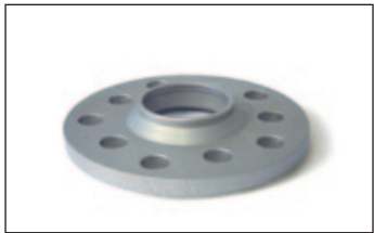
Artikel-Nr./Part-no. 20255570A: Radnabellänge max. 15 mm. Felgeninnenfase mind. 7x45° Wheel hub length max. 15 mm. Inner bavel 7x45°.
