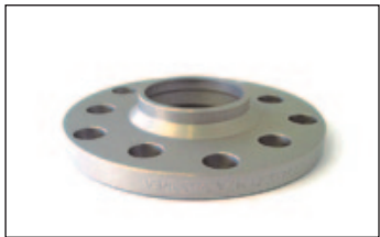
Artikel-Nr./Part-no. 24255571: Radnabellänge max. 15 mm. Felgeninnenfase mind. 5x45° Wheel hub length max. 15 mm. Inner bavel 5x45°.
